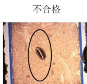
图 B.4 电极凹陷图
