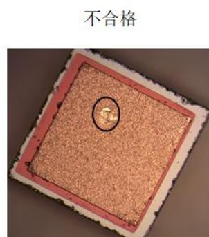
图 B.3 电极点式划痕图
